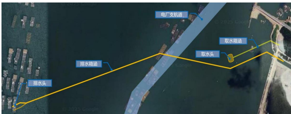
图 2.1-3 主体工程取排水管线示意图
